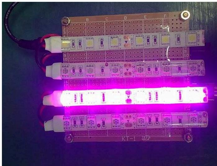
圖五 LED 燈條電路板
