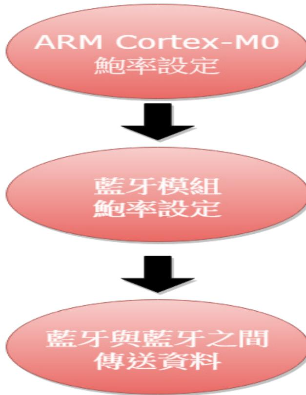
圖四：資料傳輸前先設定鮑率的程序
