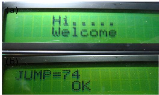
圖十一 微控器上 LCD 顯示脈搏數
