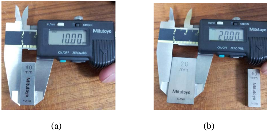
圖8 說明數位型游標卡尺校驗結果(a)10mm 快規校驗，(b)20mm 快規校驗
