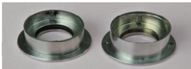
圖十 研改前後的軸封本體與鍵板
