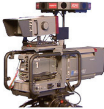
圖七：攝影機及裝置完成的紅外線發射器 (圖片來源：XYNC 公司網頁)
