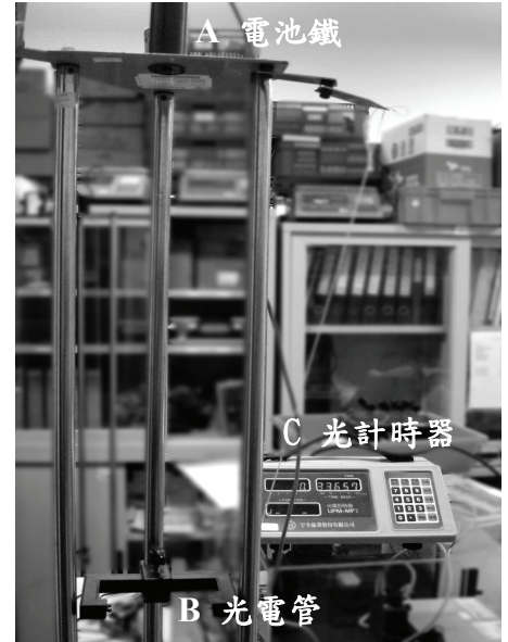
圖(1) 自由落體實驗裝置圖
