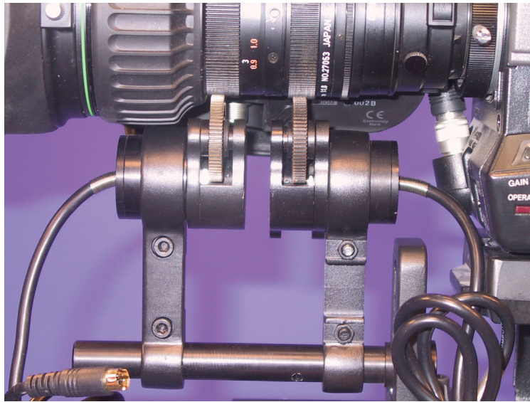
圖2-1：攝影機鏡頭的電子機械式追蹤系統（Zoom、Focus）
