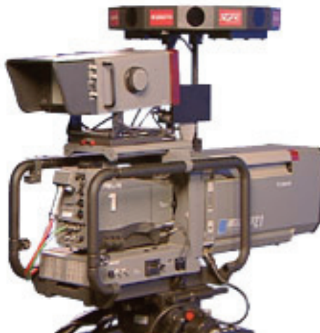
圖2-9：攝影機及裝置完成的紅外線發射器
