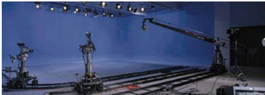
圖2-2：電子機械式追蹤系統所採用的軌道及攝影機搖臂
