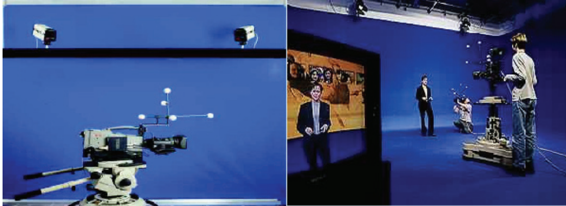
圖2-12：被動式紅外線追蹤系統
