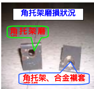
圖十八 角托架磨損
