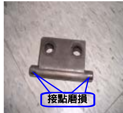
圖十七 支軸磨損
