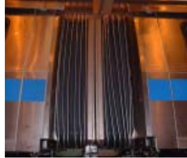
圖三十 改善後之車間通道橡膠護罩
