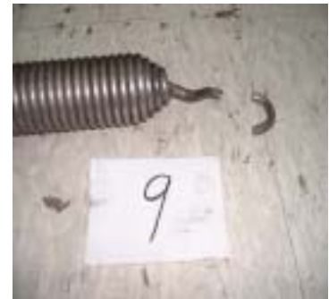
圖十二 張力彈簧斷裂
